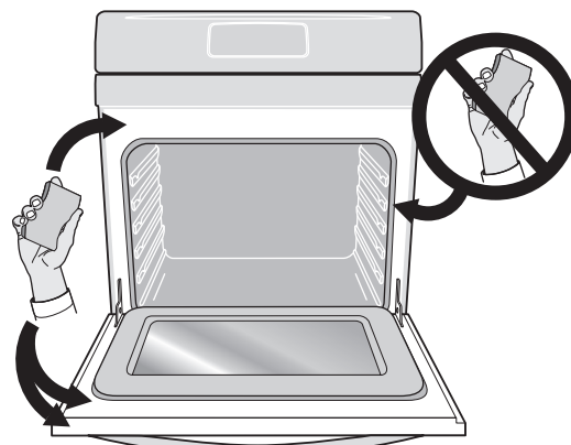
Figure 30 : Zone de la porte du four qu'il faut nettoyer et ne pas nettoyer (joint)
