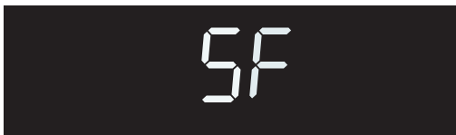
Figure 28 : Affichage illustrant une défaillance du mode sabbat
