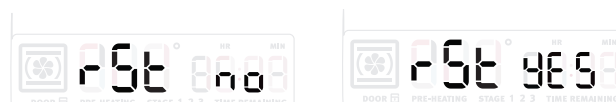
Figure 28 : Le four est maintenant prêt à se réinitialiser aux réglages par défaut
