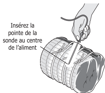
Figure 24 : Positionnement correct de la sonde
