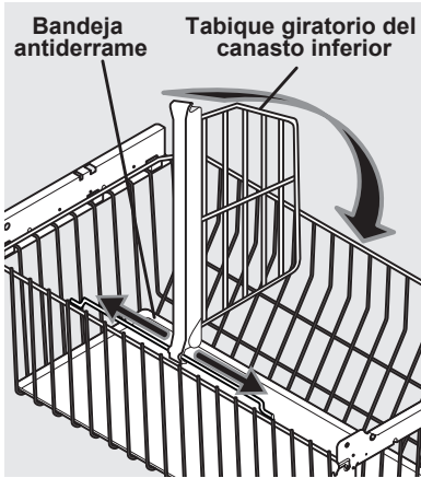
Tabique giratorio de canasto inferior (algunos modelos)
