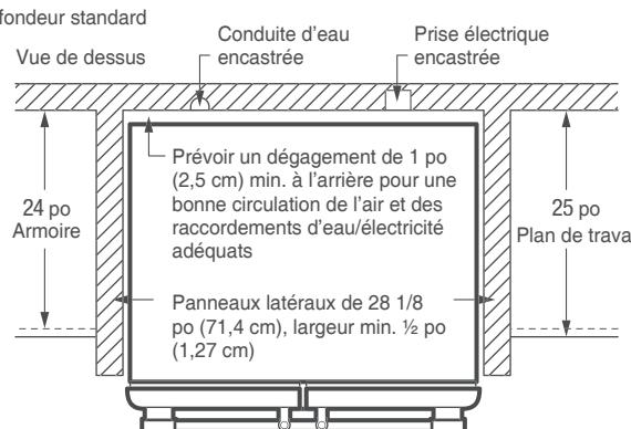
**Remarque :** Pour fins de planification seulement. Consultez systématiquement les codes locaux et nationaux d'électricité, de gaz et de plomberie. Reportez-vous au guide d'installation du produit pour des instructions d'installation détaillées sur le web à [frigidaire.com/frigidaire.ca](http://frigidaire.com/frigidaire.ca).
