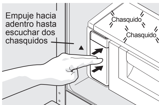
Reinstalación del filtro de agua
