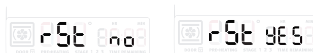
Figure 44 : Le four est maintenant prêt à se réinitialiser aux réglages par défaut
