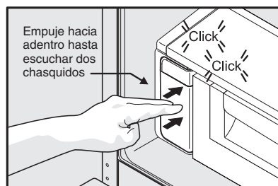
Vuelva a instalar el filtro de agua
