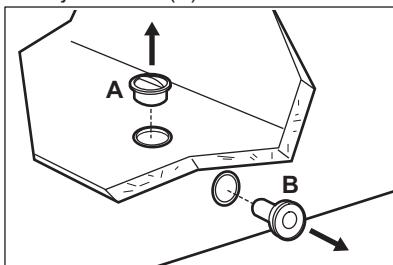
Coloque una bandeja poco profunda debajo de la salida del drenaje para recoger el agua. Compruebe la bandeja para evitar que el agua se desborde.
