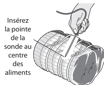
Figure 14 : Insérer la sonde dans la partie la plus épaisse de l'aliment
