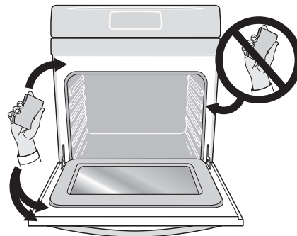
Figure 19 : Nettoyer la partie autour du joint de la porte du four
