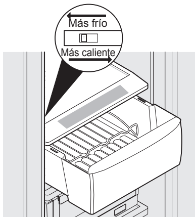
Cajón de enfriamiento con control de temperatura
