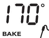
Figure 13: Jeu de sondes indiquant la température de la sonde
