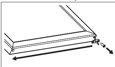
9. Coloque la esquina inferior izquierda de la puerta en la bisagra inferior; a continuación, instale la bisagra superior en el compartimento. Asegúrese de que la puerta esté nivelada y se selle correctamente contra el compartimento. Fije de forma segura los 3 tornillos y vuelva a poner el tapón superior sobre la bisagra haciendo presión.
