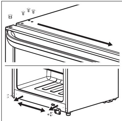
6. Desatornille los pasadores de ambas bisagras y páselos al orificio roscado del lado opuesto. Vuelva a instalar la bisagra inferior en la esquina izquierda del compartimento. Utilice los mismos 3 tornillos que se quitaron en el paso 4.
