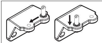
7. En el borde inferior de la puerta, pase el soporte de tope de puerta y el buje a los orificios del lado opuesto.
