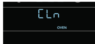
Figure 38 : L'icône Clean lock (Verrouillage nettoyage) clignote lorsque la porte se déverrouille
