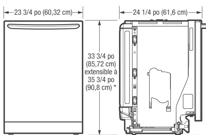
\* La hauteur ne peut être étendue jusqu'à 35 3/4 po max. que dans une installation en découpe d'armoire standard de 35 3/4 po max.
