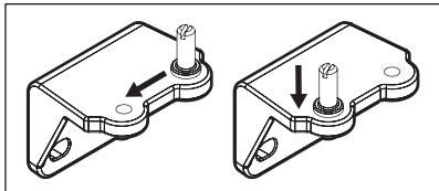
7. Sur le bord inférieur de la porte, transférez le support de butée de porte
