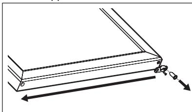
9. Placez le coin inférieur gauche de la porte sur la charnière inférieure, puis installez la charnière supérieure sur le meuble. Assurez-vous que la porte est bien à niveau et qu'elle ferme correctement contre le meuble. Fixez solidement les 3 vis et remettez le capuchon supérieur en place sur la charnière.
