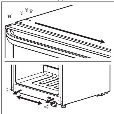
6. Dévissez les goupilles des deux charnières et transférez-les dans le trou fileté situé sur le côté opposé. Réinstallez la charnière inférieure dans le coin gauche de l'unité. Utilisez les mêmes 3 vis retirées à l'étape 4.
