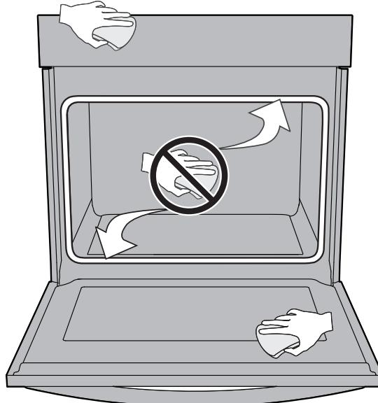
**Figure 14: Nettoyer le pourtour du joint de la porte du four**
