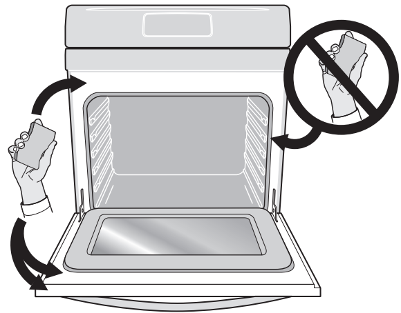
Figure 14 : Nettoyer la partie autour du joint de la porte du four
