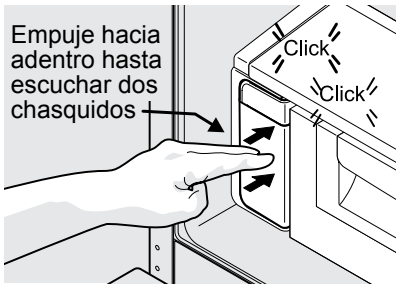
Reinstalación del filtro de agua
